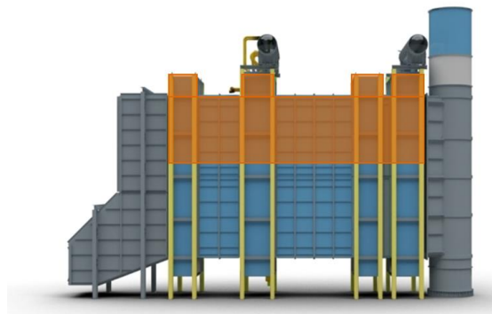
Figure 4. The 'attic' region of a typical horizontal HRSG unit.
